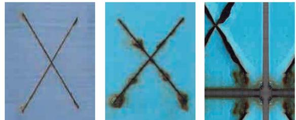
Sistema Si-COAT 579 AC de una sola capa sin imprimador, aplicado directamente sobre el acero oxidado.
